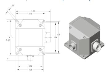
Nema 4X, Conduit Hubs (B6 enclosure)
